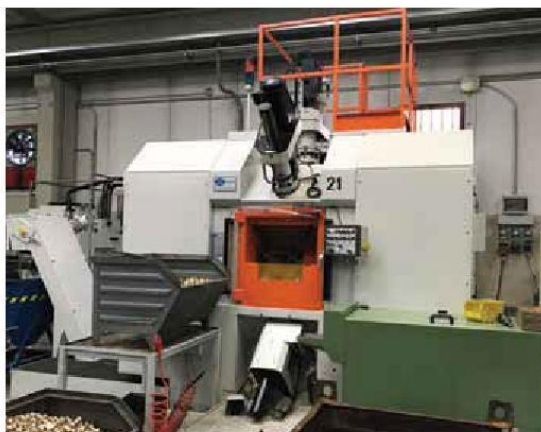
Il transfer 8S-15U-CN-HY con tavola rotante ad asse orizzontale retrofittato con i componenti OSAI
